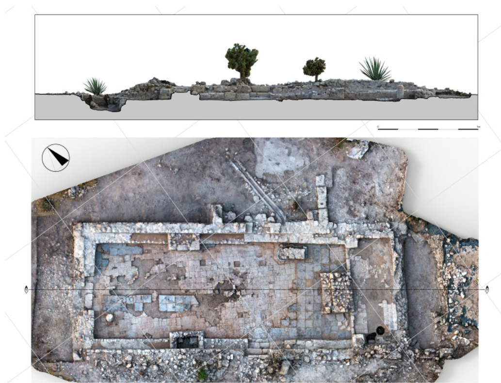
Fig. 5 - CAGLIARI - Capo Sant'Elia. Rilievo fotogrammetrico della chiesa a fine campagna di scavo, con pianta e sezione (F. Nieddu)
